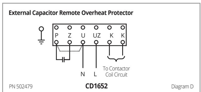
**WIRING DETAIL: SINGLE PHASE FANS USING TERMINAL BOX ON MOTOR**
